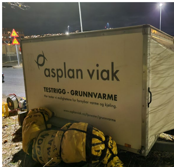
Figur 41 Plassering av testborehull vises som blå markeringer i bildet til venstre, testriggeren ved utførelse av termisk responstest vises til høyre.
