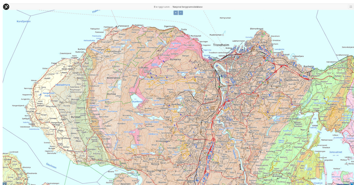
Figur 37 Berggrunnskart over Trondheim. Berggrunnen på Ladehammeren er kartlagt som grønnstein (metabasalt) og grønnskifer (lys brun farge). I byen for øvrig finnes gråvacke (grønn farge) samt trondhemitt (rosa farge).
