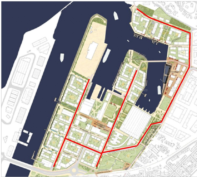
Figur 46 Illustrasjon av antatt hoved trasé for rørføring i en sentral termisk energiforsyning. Traseene er antatt lik for alle konseptene. Totalt utgjør hovedtraseen om lag 2,2 km grøft.
