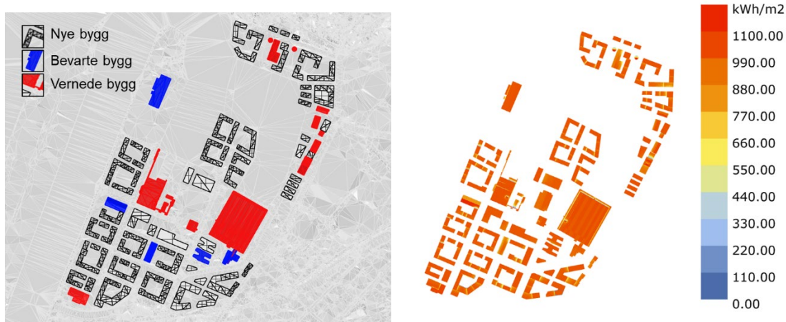
Figur 17 Bygningsmassen i Nyhavna som har vært gjenstand for en solenergisimulering. Til høyre ses resulterende innstrålt solenergi per m 2 i et «solkart» over bebyggelsens takområder.
