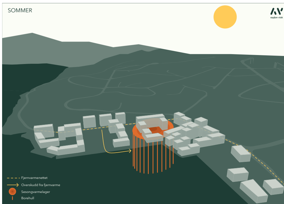
Figur 11: Lading av borehullene i sesongvarmelageret med overskuddsvarme fra avfallsforbrenningen på Heimdal om sommeren
